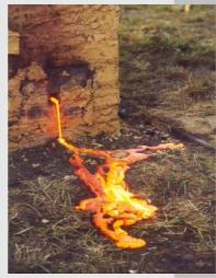
La réalisation de ce couteau a nécessité près de 120 heures de travail, toutes les opérations ayant été réalisées entièrement à la main (transformation du bois en combustible, collecte in situ du minerai et des matériaux du manche, fabrication du four en argile...).
